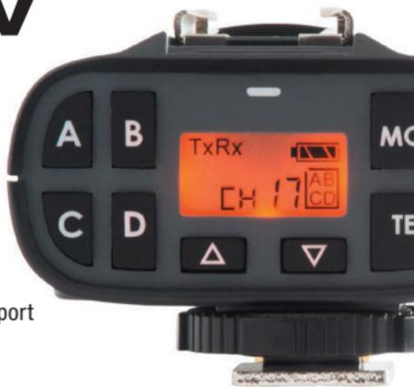
Dieser Transceiver mit automatischer Erkennung kann je nach Bedarf als Funksender oder -empfänger zur drahtlosen Synchronisierung von Blitzgeräten oder zur Fernauslösung einer Kamera verwendet werden.
